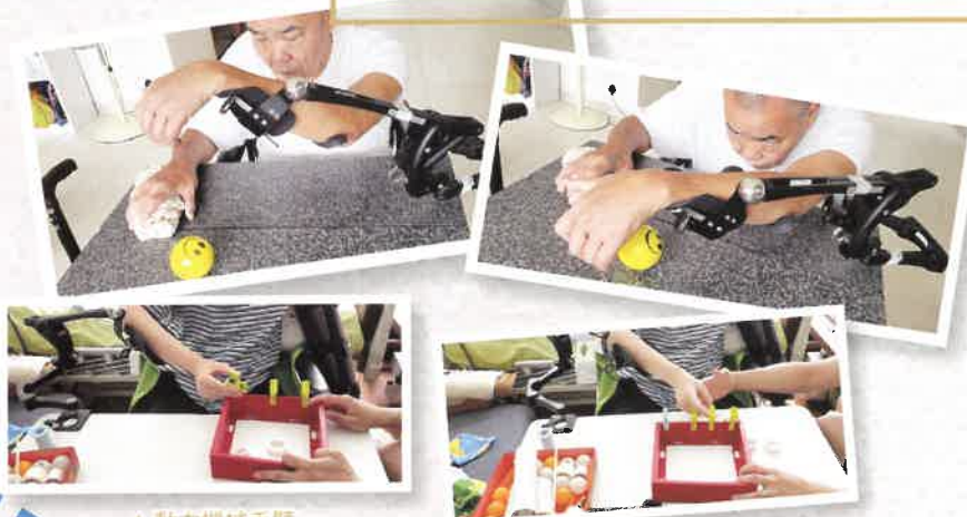
▲ 動力機械手臂 協助個案以較少的力量移動手臂，適合難以提高手臂、運用手部或缺乏氣力人士使用，可以輔助個案進行吃飯、喝水等日常生活活動。
